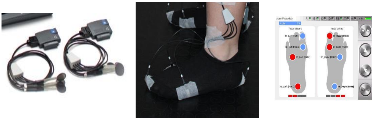
Fig. 5. Esempio di posizionamento di elettrodi per l'analisi del foot switch.
